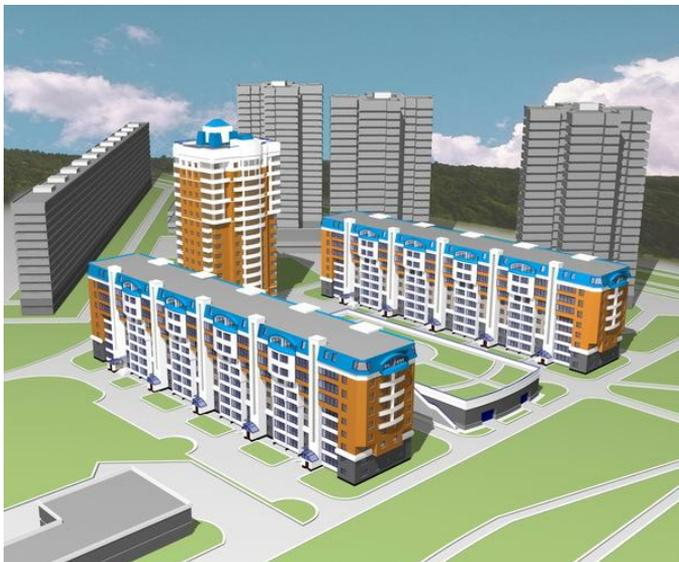
Рис.10. Идея реконструкции группы старых пятиэтажных домов путем сноса серединной пятиэтажки, возведения на ее месте подземной парковки и реконструкции двух крайних домов.
