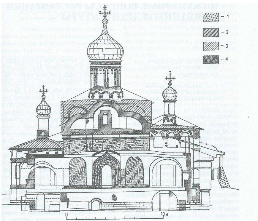
Рис. 8. Картограмма выполненных работ. Исполнительный чертеж. Церковь Зачатья Анны в Зарядье. 1-восстановленная белокаменная кладка; 2-восстановленная кирпичная кладка; 3-новые кровли; 4-новые парапетные стенки, выполненные в связи с приспособлением памятника.
