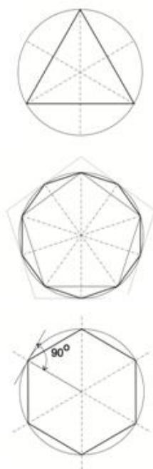
Рис. П 4.2. Аппроксимация окружности многоугольниками
